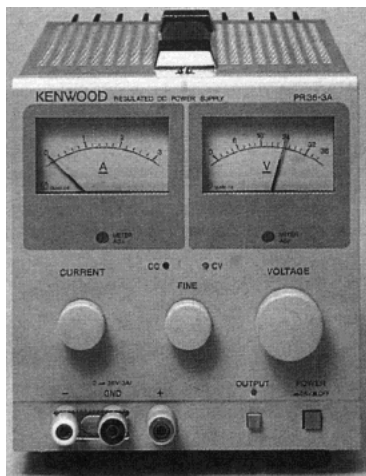
Fig. S7 Alimentatore stabilizzato da laboratorio.
